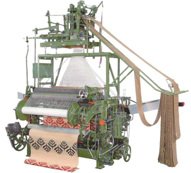
Telar inventado por Joseph Marie Jacquard (1801). Permitía tejer complicadas puntadas en forma automática. Como con él una sola persona realizaba el trabajo de varios, fue amenazado de muerte.
